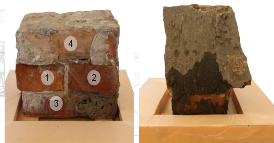
Фрагмент кирпичной кладки после окончания первого этапа исследования
